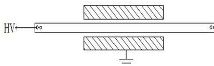
图 6-8 套管接法
