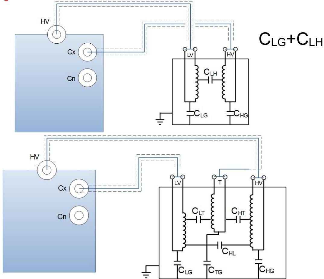
三绕组变压器  $C_{HG}+C_{HL}$  (高压线屏蔽接 T 绕组)
