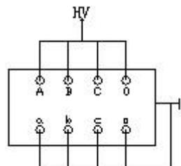
图 6-10 变压器接法
