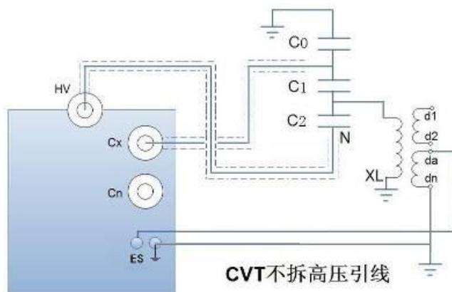
4、反接屏蔽法测量 CVT 上端 C0 的电容值和介损测量模式：反接法。电压  $\leq 2kV$
